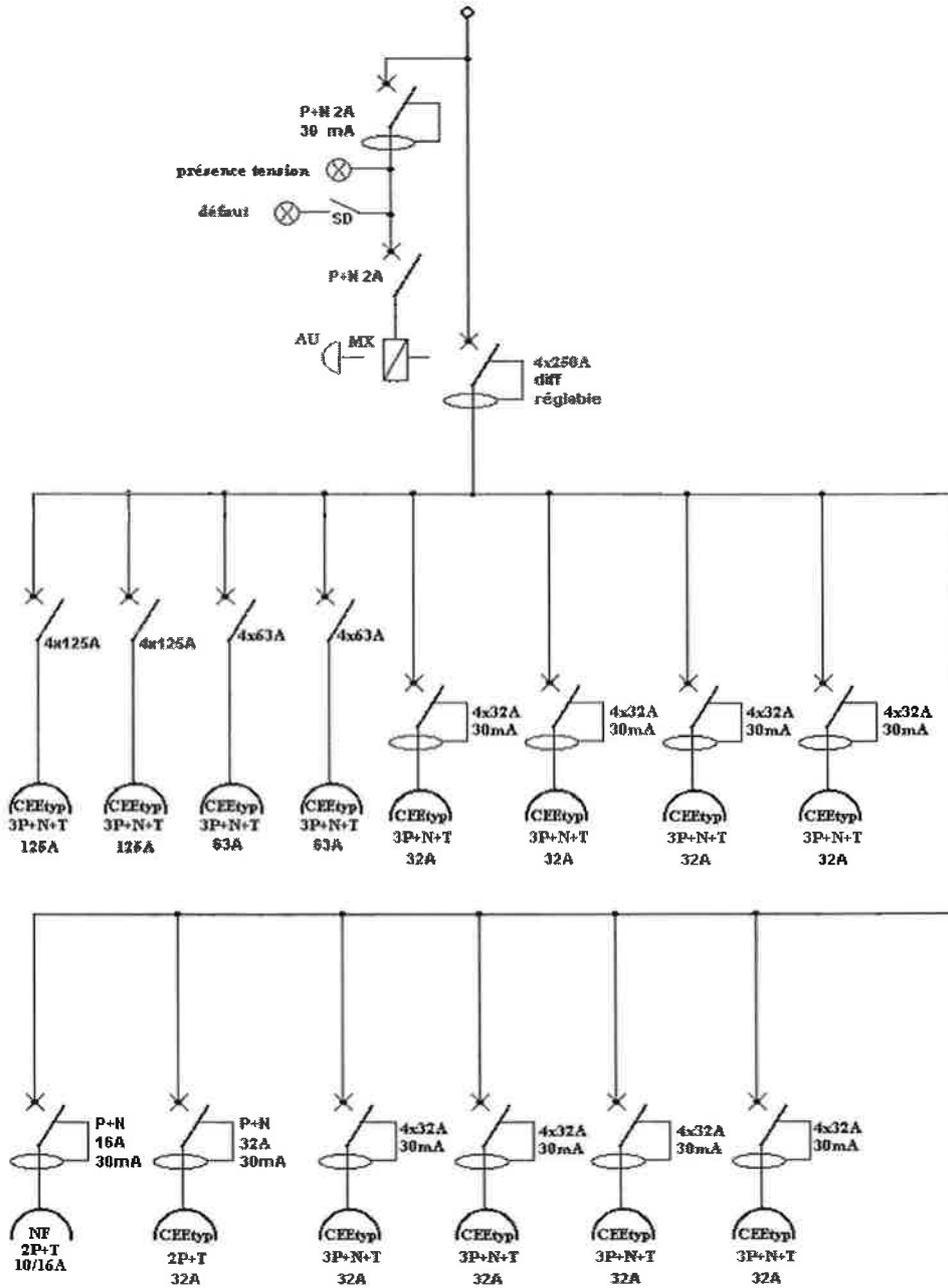
Conformément à votre demande : pas de verrouillage électrique sur les prises 63 et 125A
